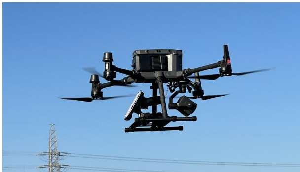
図3 実証実験で使用するドローンにカメラとハンディターミナル・高出力ユニットをペイロードし飛行する様子
