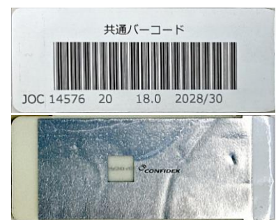
図4 共通バーコード(表面)と裏面(RFIDタグは内蔵)
